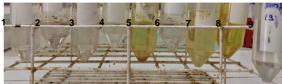
Figura IV.3. Amostras de óleo digeridas a partir dos testes multivariados mostrados na Tabela 6. Ensaios de 1 a 9, com variação da massa de amostra (0,05; 0,075 e 0,10 g), concentração de HNO 3 (8,34, 11,34 e 14,34 mol L -1 ) e volume de H 2 O 2 (3, 4 e 5 mL)
